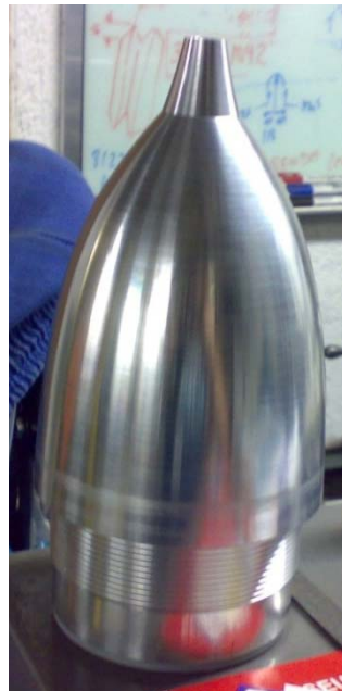
Figura 4.25 – Peça finalizada (nariz do penetrômetro)
