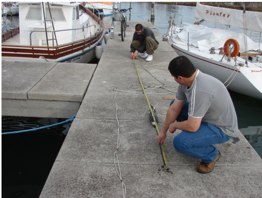
Figura 4.54 – Medição do deslocamento com a trena
