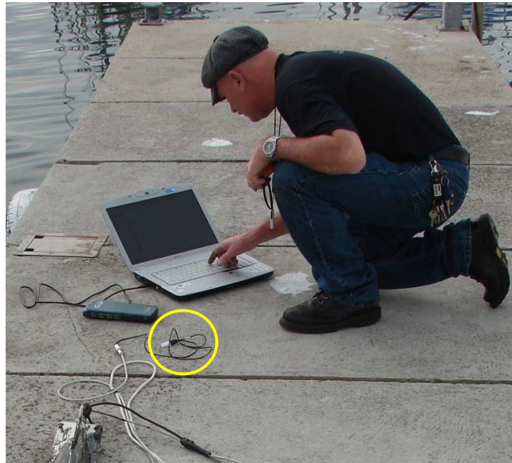
Figura 4.51 – Configuração dos parâmetros para coleta de dados. Observar que o cabo não está conectado ao LabPro ®
