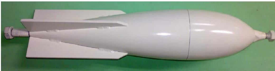
Figura 4.35 – Corpo do penetrômetro pintado com tinta para galvanizado e alumínio
