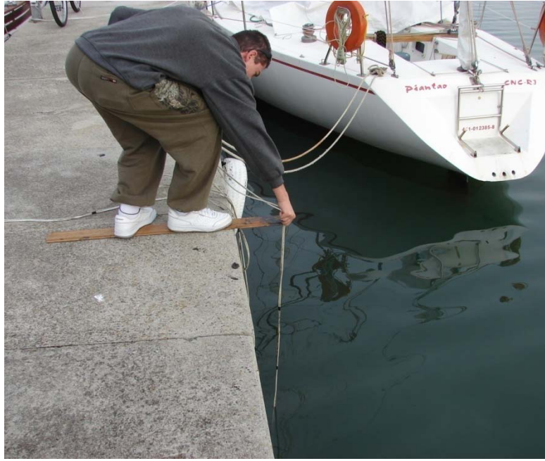
Figura 4.53 – Medição manual do deslocamento vertical do penetrômetro
