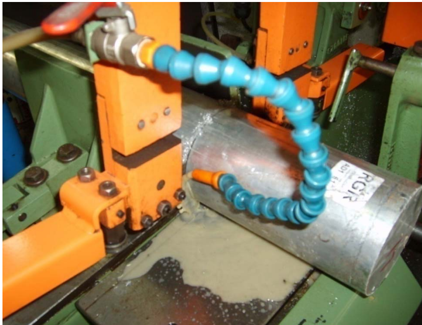
Figura 4.14 – Operação de corte do tarugo de alumínio na serra de fita
