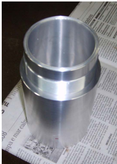
Figura 4.21 – Conclusão da usinagem do nariz do penetrômetro em torno comum
