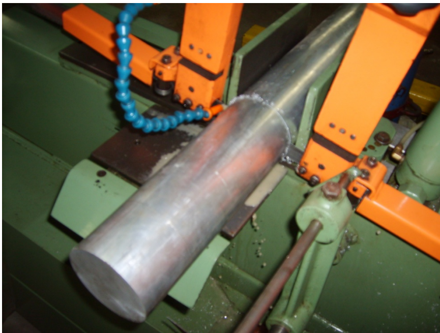
Figura 4.26 – Corte do tarugo de alumínio para construção da cauda
