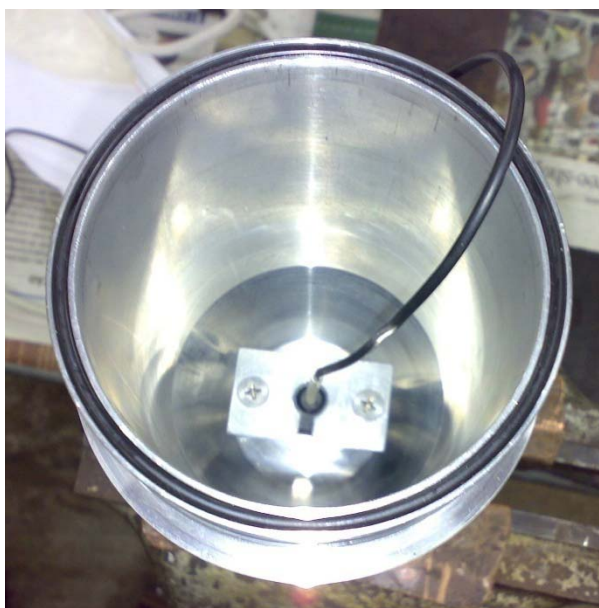
Figura 4.42 – Fixação do acelerômetro ao nariz do penetrômetro
