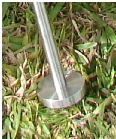
Figura 4.45 – Sapata de 50 milímetros de diâmetro fixada na ponta da haste
