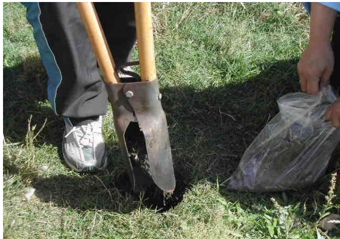
Figura 06- coleta de amostra de material de aterro
