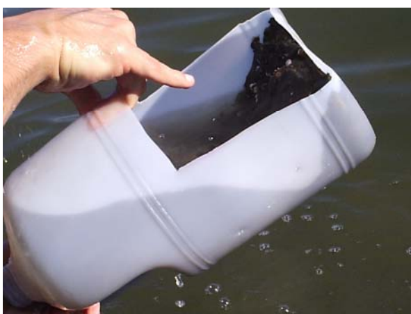
Figura 08 - Coleta de sedimentos
