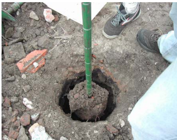
Figura 10 – Perfuração do material de aterro
