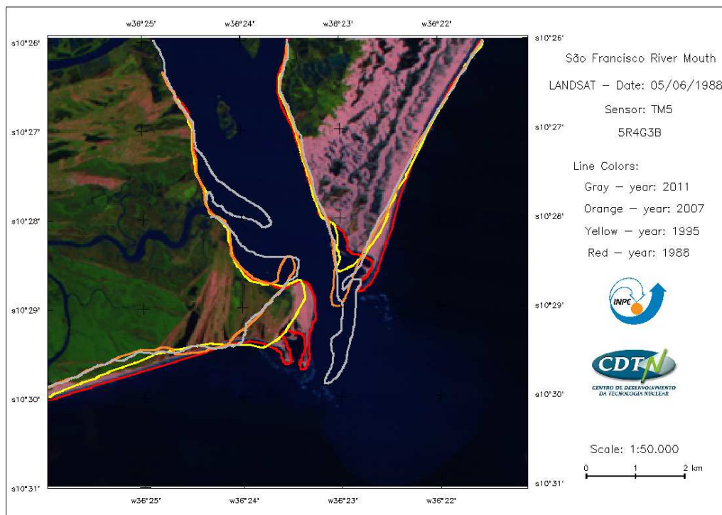
Figura 16. Contornos da costa na região da embocadura do Rio São Francisco (anos 1988, 1995, 2007 e 2011) baseados em imagens do satélite Landsat. [10]
