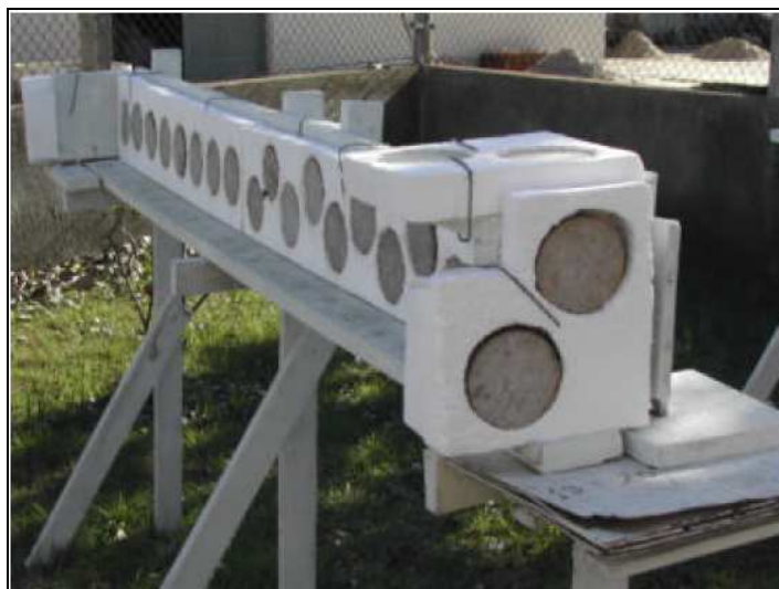
Figura 2. Rack com testemunhos para a medição do GS desta e de outras pesquisas
