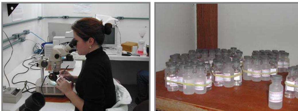
Figura 16 - Separação em estereomicroscópio e armazenagem em frascos
