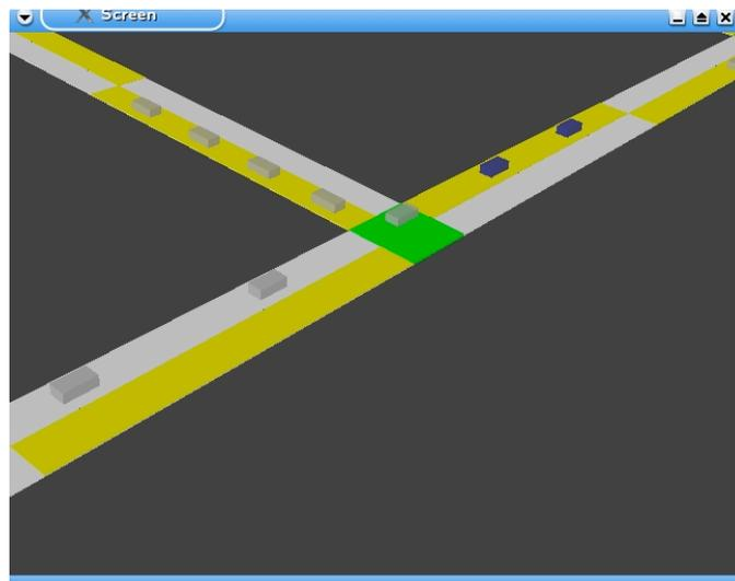
**Figura 3-1 – Imagem de um cruzamento com acesso controlado sem uso de semáforos.**
