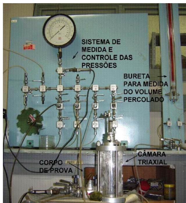
Figura 11. Arranjo experimental para medida da permeabilidade – ensaio de permeâmetro de parede flexível em câmara triaxial (ref.[10])
