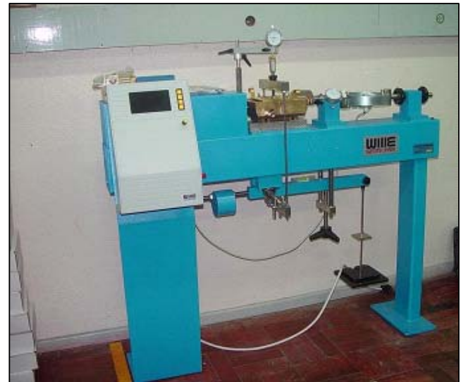
Figura 8. Moldagem de amostras (a e b) e equipamento (c) para ensaios de cisalhamento direto
