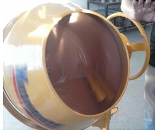
Figura 2. Preparação da mistura de solo artificial
