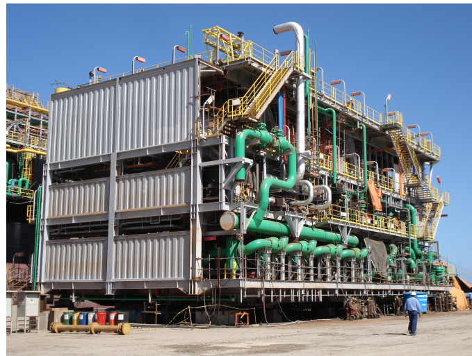
Figura 3: Módulo (Unidade Pré-Montada)
