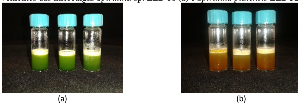
Figura 2 - Emulsões formadas com 10% de óleo girassol obtidas a partir de extratos provenientes das microalgas Spirulina sp. LEB 18 (a) e Spirulina platensis LEB 52 (b).
