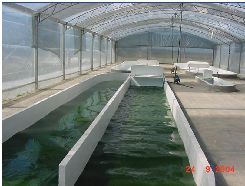
Figura 1: Fotobiorreatores onde é realizado o cultivo de Spirulina platensis na planta de Santa Vitória do Palmar (Rio Grande do Sul).
