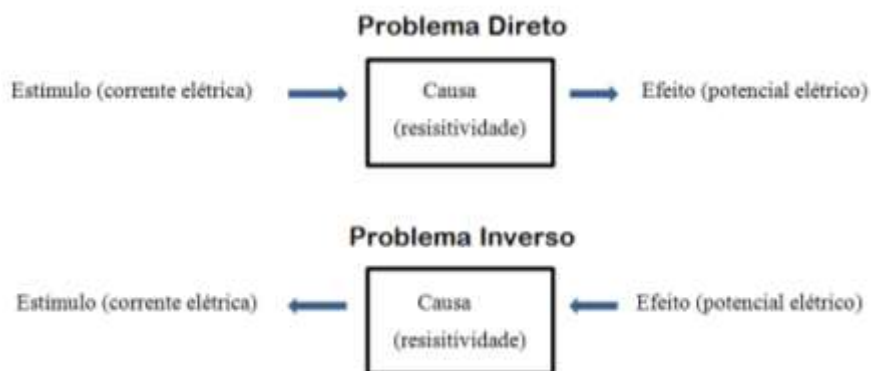
Figura 12 – Diagrama esquemático dos problemas direto e inverso na TIE
