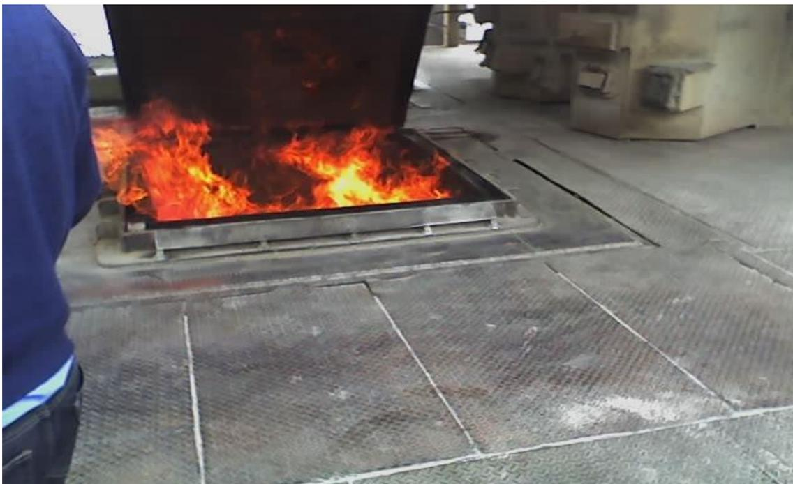
Imagem 3: Bocal do forno de desidratação do calcário
