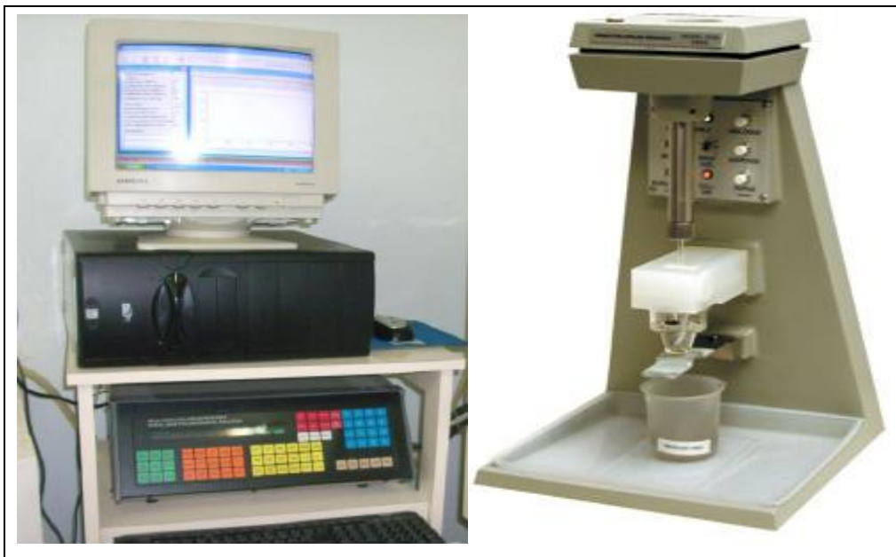
Figura 9 - Equipamento Polarográfico Modelo 394B e o Sistema de Eletrodos 303A Interfaceado ao Microcomputador.
