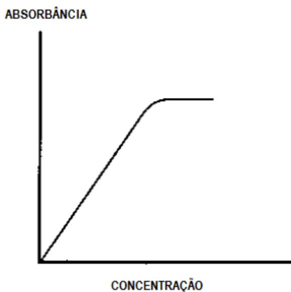
Figura 2 - Gráfico da variação da absorbância em função da concentração do analito. Adaptado de Armienta et al. (2009).
