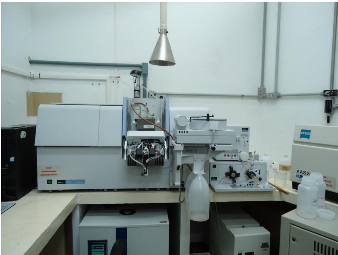
Figura 5 - Espectrômetro de absorção atômica com geração de hidretos e injeção em fluxo da Perkin Elmer.
