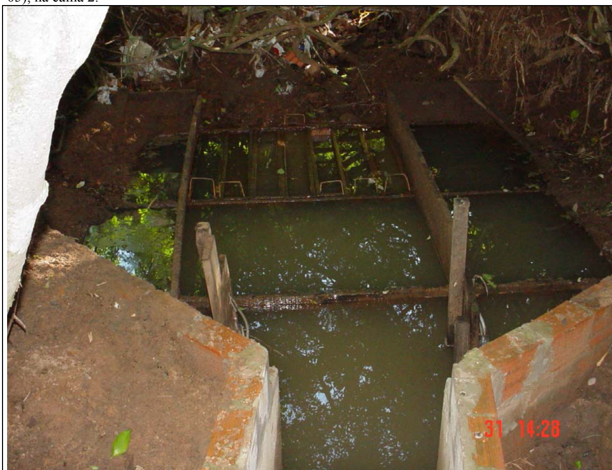
Figura 5. Amostradores tipo fossa de sedimentos em operação
