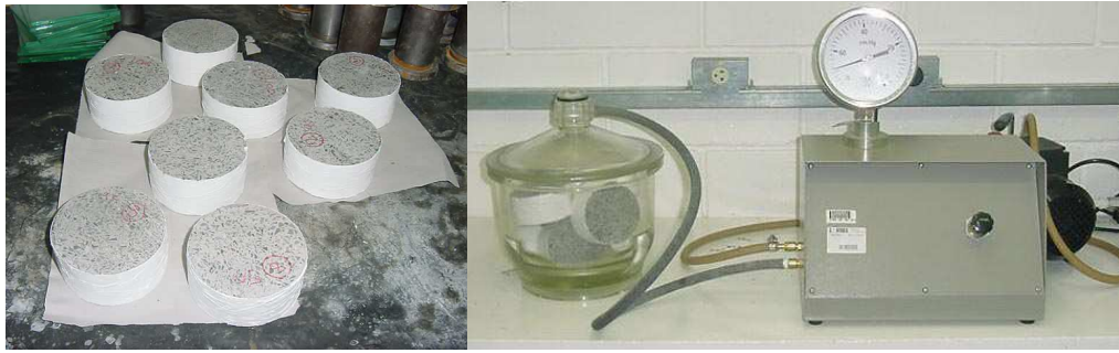
FIGURA 7 – Selagem de amostras lateralmente para ensaio de resistência à penetração de cloretos e acondicionamento de amostras em dessecador a vácuo para ensaio de resistência à penetração de cloretos.
