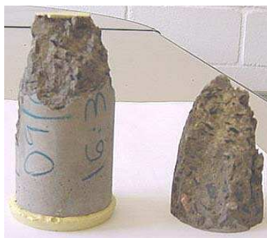
FIGURA 6 – Forma de ruptura de corpos-de-prova preparados por capeamento com enxofre e de topos retificados
