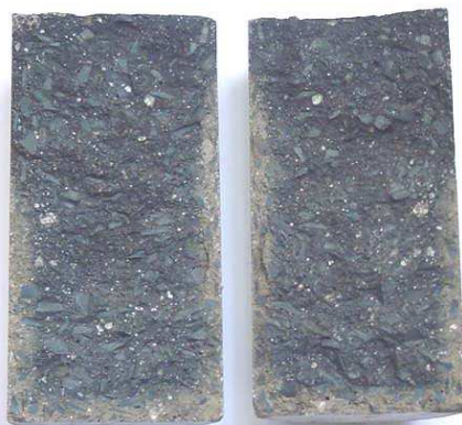
FIGURA 9 – Corpo-de-prova fraturado após quatro dias da aspersão da solução de nitrato de prata
