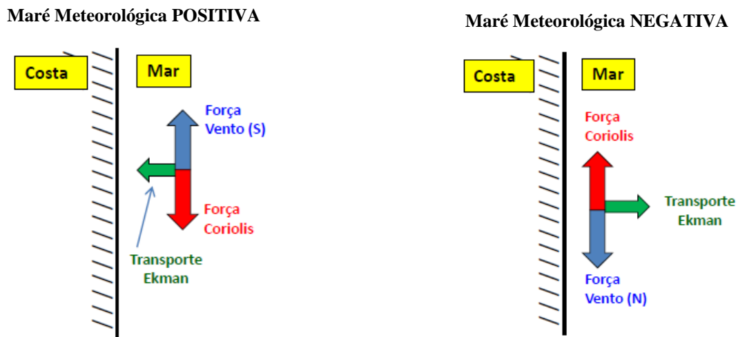
Figura I.6 - Mecanismo físico (esquemático) para geração local de MM na costa S/SE brasileira pelo vento (hemisfério Sul). Maré Meteorológica POSITIVA : Vento com a costa a sua esquerda induz transporte de água (transporte de Ekman) do mar para a terra provocando sobre-elevação do nível. Maré Meteorológica NEGATIVA: Vento com a costa a sua direita, o efeito é invertido e a água é afastada da costa provocando um rebaixamento do nível.
