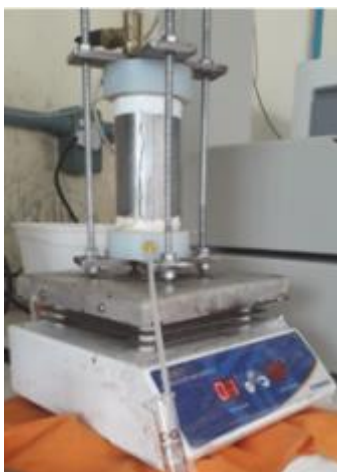
Figura 7 - Aparato utilizado para ultrafiltração em laboratório
