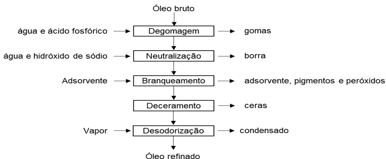
Figura 3 - Fluxograma do refino químico do óleo de arroz
