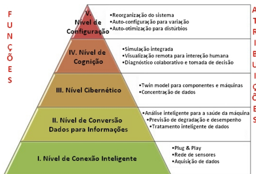
Figura 4: Arquitetura 5C para CPS com funções e atributos de cada camada. Fonte: Adaptado de (Lee et al. 2015)
