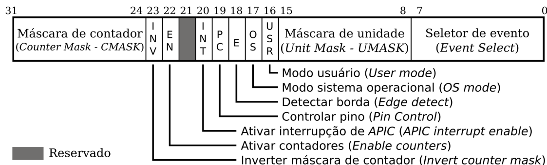
Figura 1: Estrutura do registrador seletor de evento versão 1 (adaptado de [1]).
