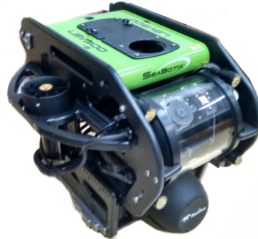
Figura 13: O robô subaquático utilizado para coleta de dados é o Seabotix LBV 300-5 acoplado com o FLS Blueview P900-130. Este sonar possui um amplo campo de visão, atingindo 130 graus de abertura
