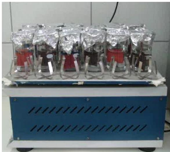
Figura 2. Experimento realizado para lixiviar os biocidas presentes nas tintas anti-incrustantes utilizadas neste estudo (em triplicata)
