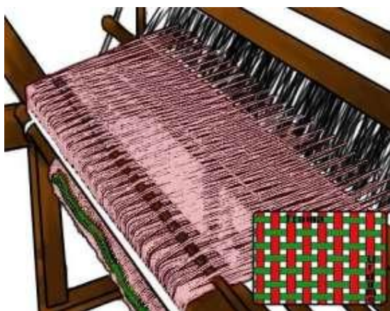
Ilustração 1 - Tear artesanal com a representação da trama e do urdume
