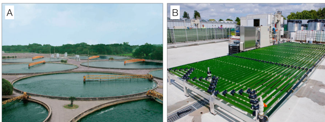
Fig. 3: Sistemas empregados para o cultivo de microalgas. a) Sistema aberto (tanques circulares), b) Sistema fechado (fotobioreator tubular horizontal). (a: www.sunchlorella.com , b: www.algaeparc.com )
