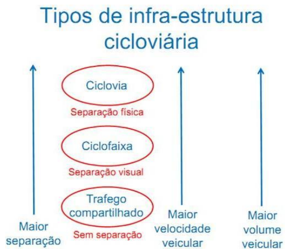
FIGURA 11 – Tipos de infraestrutura cicloviária segundo características da via. Fonte: I-CE (2007).
