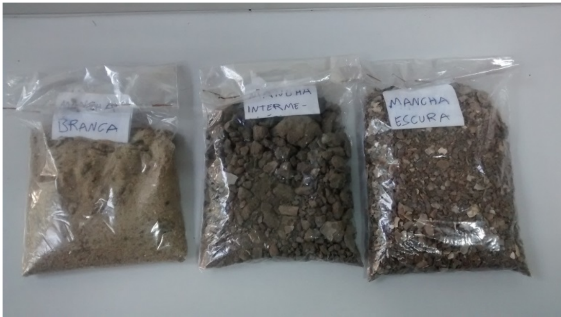
Figura 3.4: Amostras sedimentológicas coletadas no parcel do carpinteiro, visando relacionar com as sonografias adquiridas, classificadas em laboratório como sendo a mancha clara referente a areia fina, mancha intermediária como areia condensada com lama e a macha mais escura como lama biodetrítica.
