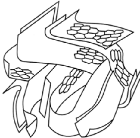
Figura 5. Representação da estrutura do carvão ativado.
