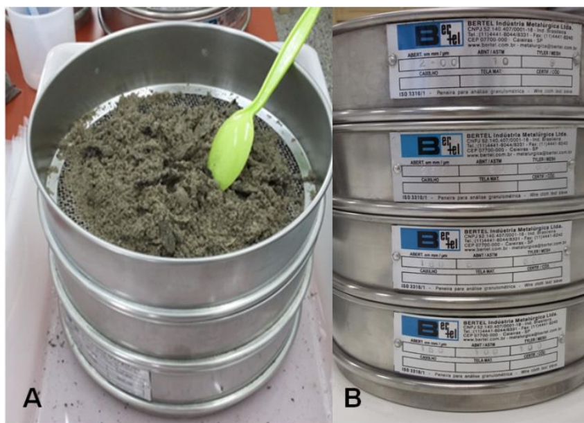
215 Figura 4: Metodologia de Peneiração (A – separação dos propágulos; B – peneiras de 216 diferentes malhas).
