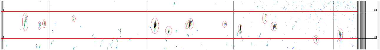
Figura 3.3: Ecograma obtido pela ecossonda SIMRAD EK500 com a área de pesca e os cardumes identificados (Fonte: Laboratório de Tecnologia Pesqueira e Hidroacústica - IO - FURG).
