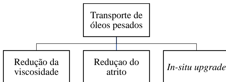
Figura 3.6: Diagrama mostrando como melhorar o escoamento do óleo pesado.
