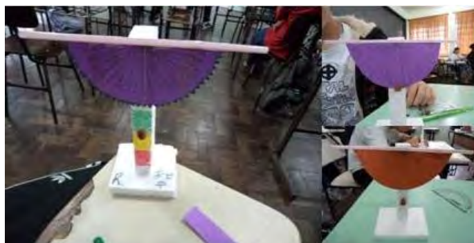
Figura 30 – Teodolitos construídos pelos alunos.
