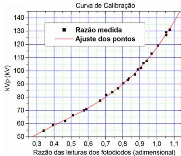
Figura 1 – Curva de calibração do Medidor 4x2 onde pode-se ver a anomalia provocada pela radiação característica do tungstênio.
