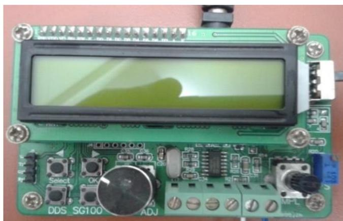
Figura 4.2 - Gerador de função modelo SG100
