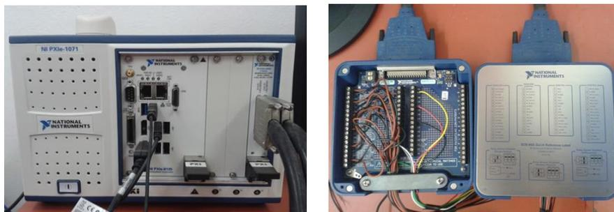
Figura 4.5 - Chassi NI PXIe-1071 com a controladora NI PXIe-8135 e com o DAQ PXIe-6363 conectado em seu *slot*, ao lado o bloco de conectores NI SCB-68
