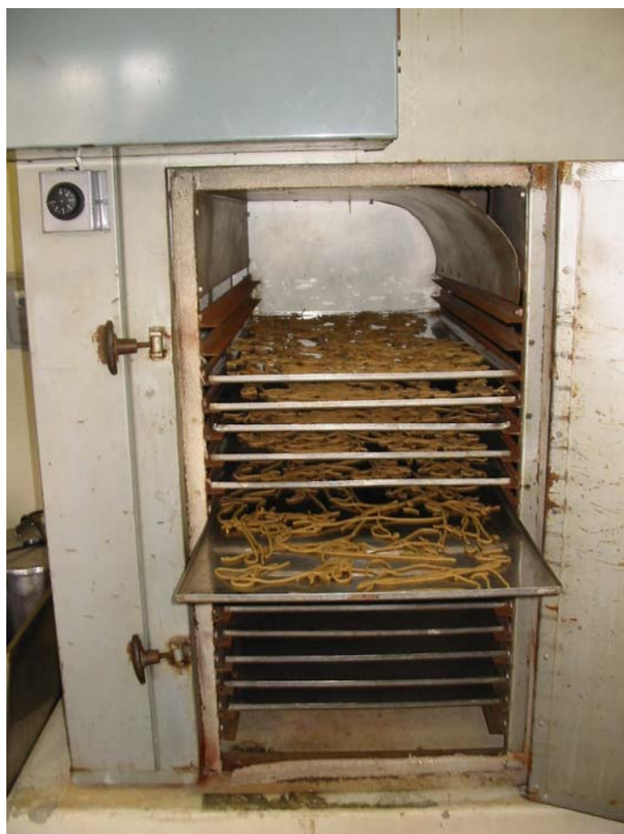
Figura 5. Secagem das dietas experimentais com diferentes níveis protéicos em um secador de escorrimento paralelo com fluxo de ar forçado.
