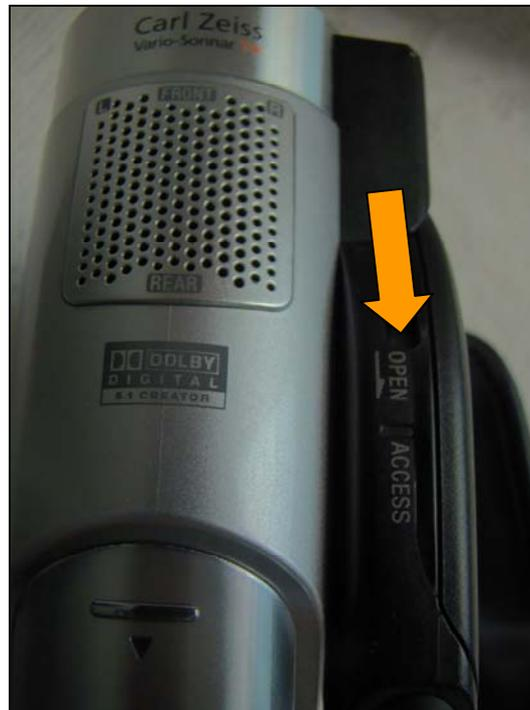
É preciso ter cuidado ao abrir este compartimento, pois a alça de mão da câmera impede que a tampa se abra por completo, sobrecarregando o motor de abertura. Antes de realizar este procedimento, certifique-se de que a alça não atrapalhe este processo.
