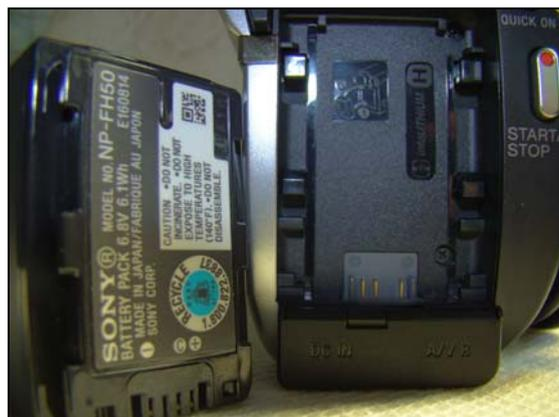
Em seguida, é necessário conectar o cabo carregador (C1a C1b) no conector DC IN.
