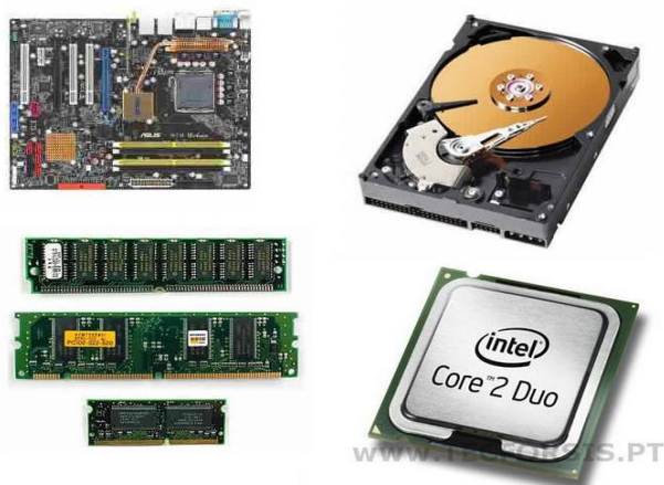
Ilustração 7: Elementos de hardware de um computador
