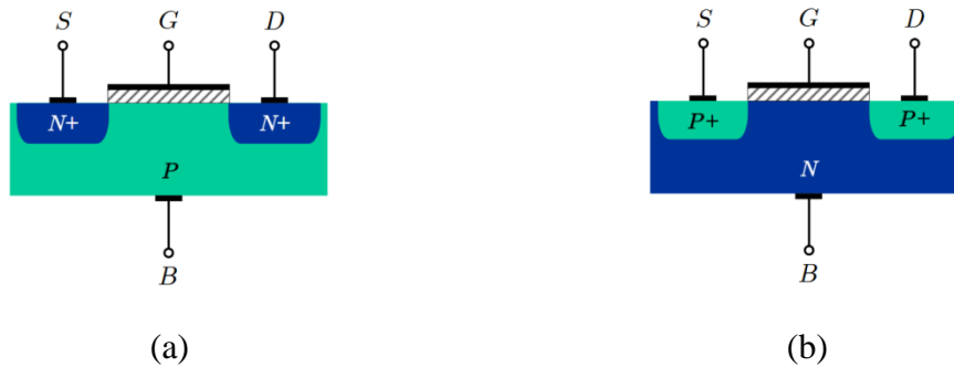
Figura 2.1: Representação dos dois tipos de transistores MOS: (a) NMOS e (b) PMOS.
