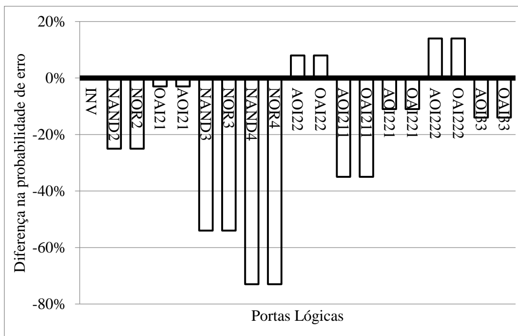
Figura 4.5 Diferença na probabilidade de erro entre o modelo original da PTM e o modelo proposto considerando falhas SOF
