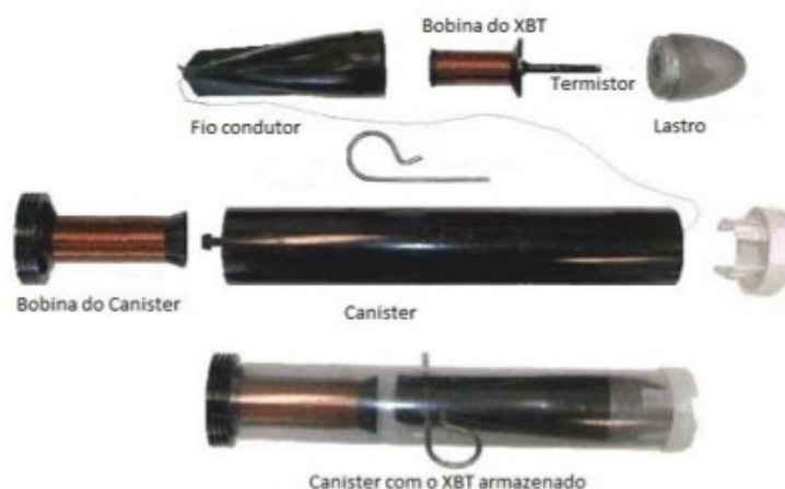
Figura2. Principais componentes do XBT. Retirado de: http://www-ium.univ-brest.fr/fr/science-et-societe/sciences-pour-tous/histoire-oceano/thermo5 e traduzido por Torquato[2016]).
