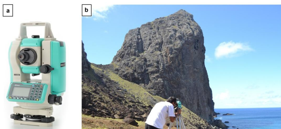
Figura 32. a- Estação total Nikon Nivo 2C. b- Levantamento dos perfis topográficos com estação total na Ilha da Trindade.
