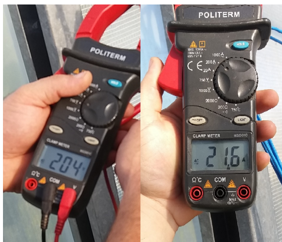
Figura 28: Leituras do Voltímetro e do Amperímetro. Fonte: Autor
