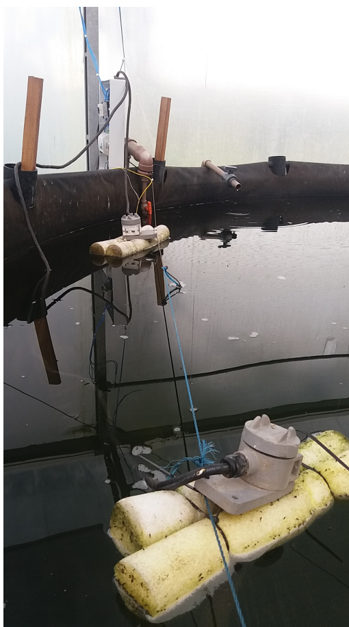
Figura 27: Resistores de aquecimento instalados em paralelo imersos no tanque. Fonte: Autor
