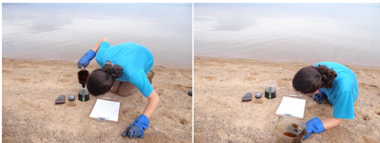
Figura 16: Em cada ponto foram inseridos 750 ml de petróleo, sendo anotado, em planilha, o tempo necessário para todo o fluido infiltrar no substrato. Foram anotadas, em planilha, as variações de tempo necessárias para cada variação de cinco milímetros no nível.
