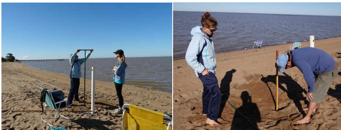
Figura 20: Instalação do trado e medição da profundidade do lençol freático (distância entre a superfície e o lençol) com auxílio de vara graduada.
