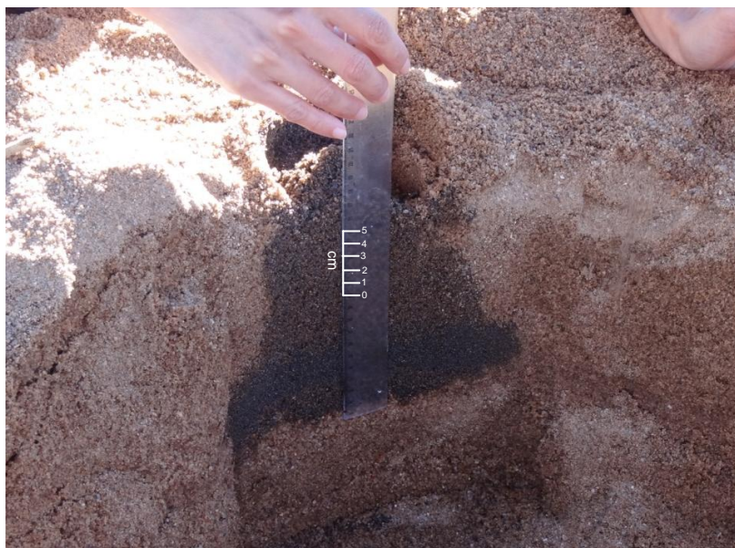
Figura 17: Gota de infiltração. Foram medidas a altura e largura máxima da gota.
