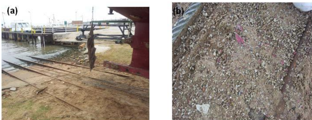
Figura 13: Estaleiro Santos no estuário da Lagoa dos Patos. (a) Local de reparo das embarcações; (b) partículas de tintas anti-incrustantes presente no local
