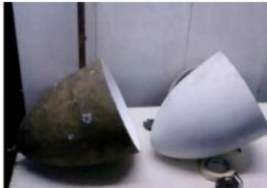
FIGURA 7.15 – Molde e cubo do rotor construído
