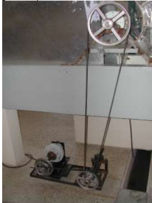
FIGURA 6.13 – Roda d'água acoplada ao alternador
