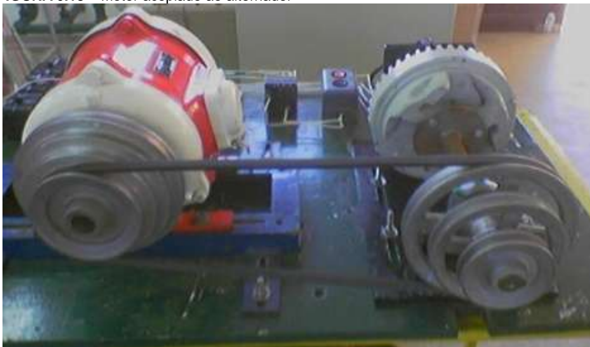
FIGURA 6.18 – Motor acoplado ao alternador
