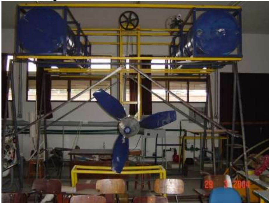
FIGURA 5.16 – Montagem turbina-balsa-sistema de transmissão
