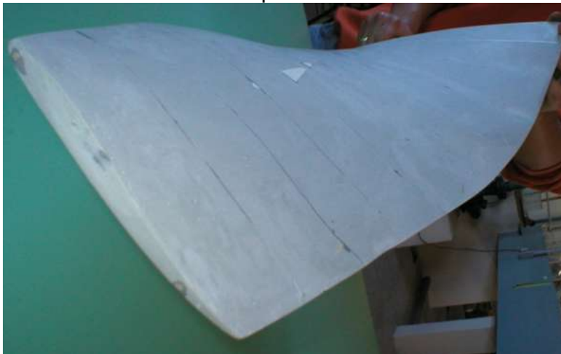
FIGURA 7.10 – Modelo reconstruído da pá.
