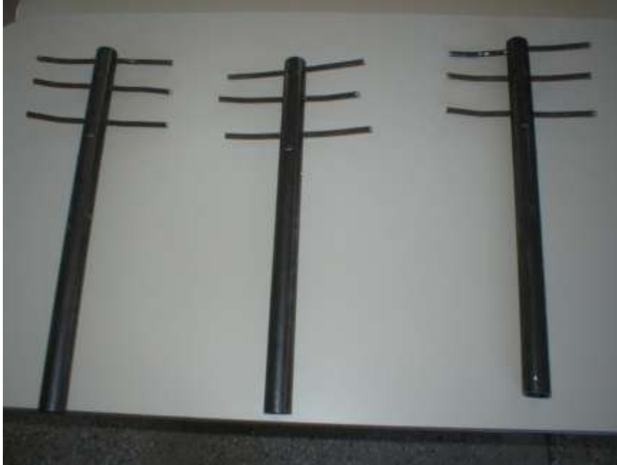
FIGURA 7.9 – Pinos de sustentação das pás
