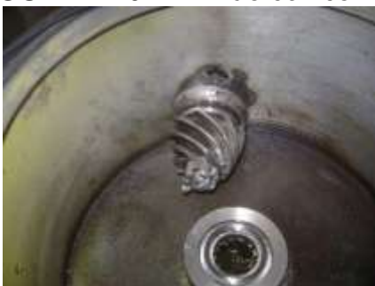
FIGURA 7.46 – Pinhão cônico montado
