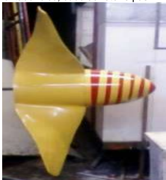
FIGURA 7.19 – Rotor montado: bico, cubo do rotor e pás
