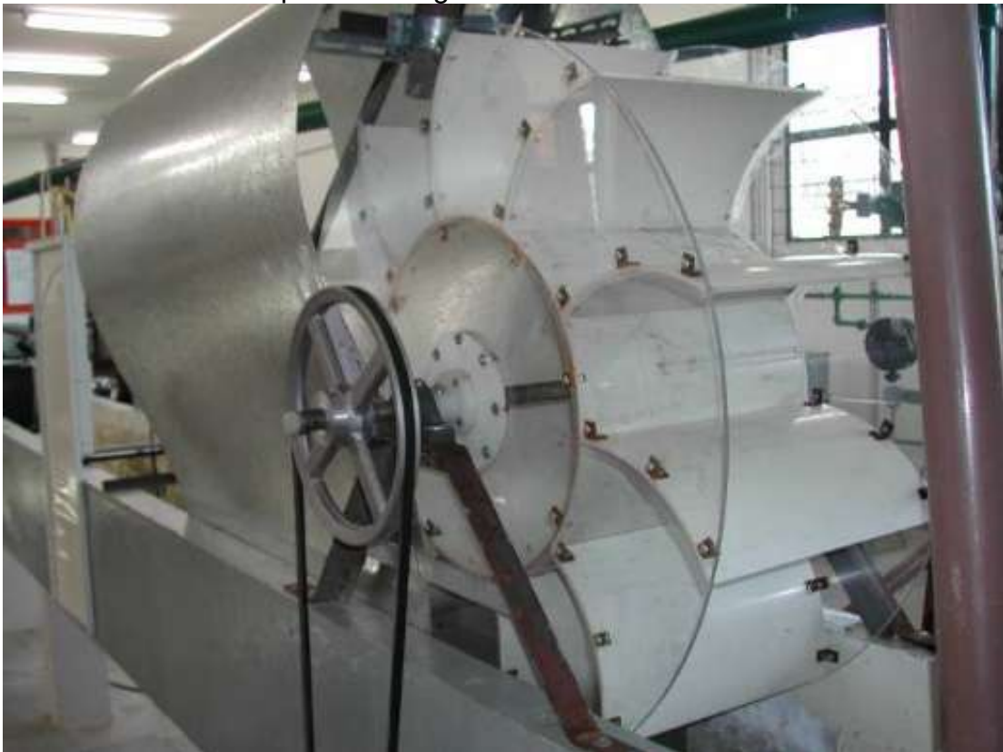
FIGURA 6.10 – Turbina tipo roda d' água
