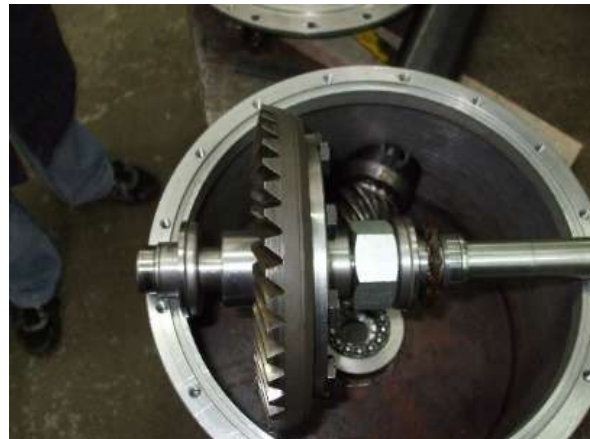
FIGURA 7.32 – Eixo inferior e seus componentes FIGURA 7.33 – Coroa cônica
