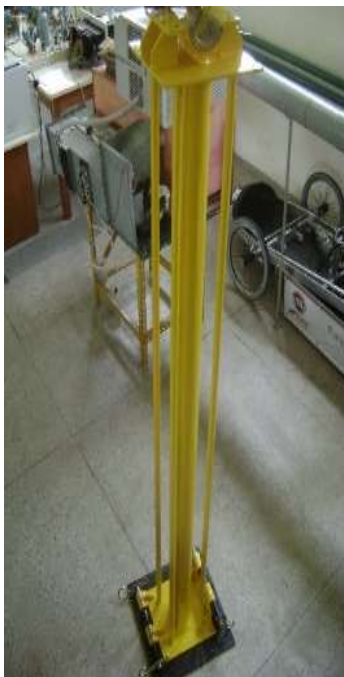
FIGURA 7.58 – Torre de sustentação da turbina FIGURA 7.59 – Chapa de fixação
