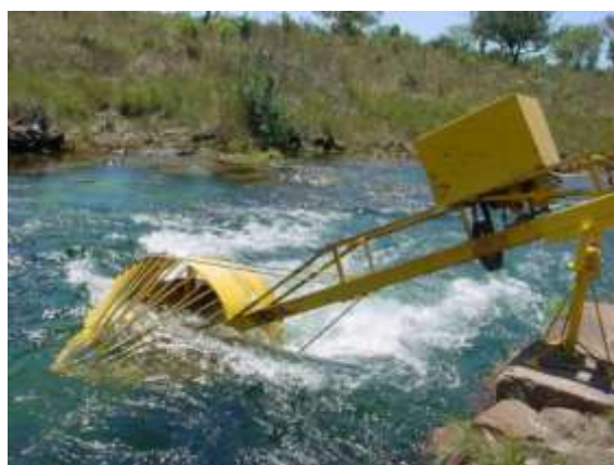
FIGURA 1.6 – THC com ancoragem sólida na margem do rio
