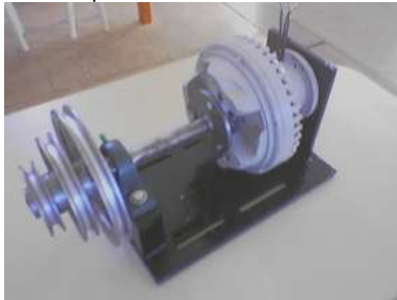
FIGURA 6.4 – Alternador e acoplamentos
