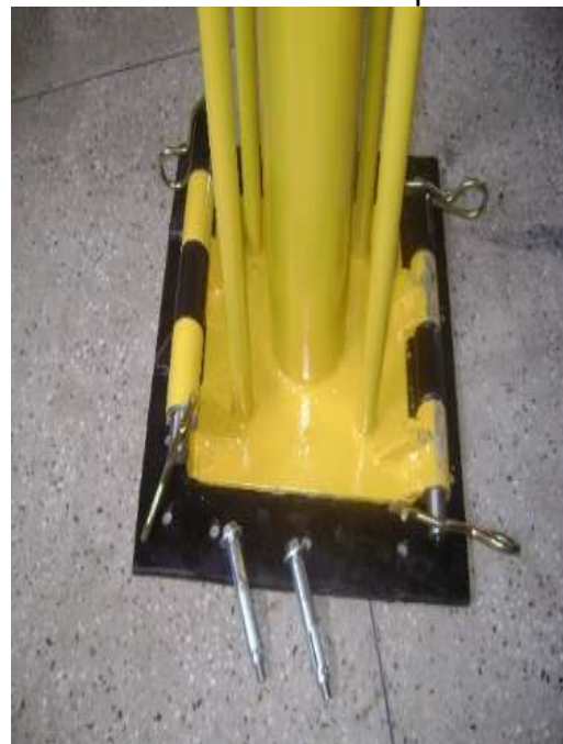
FIGURA 7.58 – Torre de sustentação da turbina FIGURA 7.59 – Chapa de fixação
