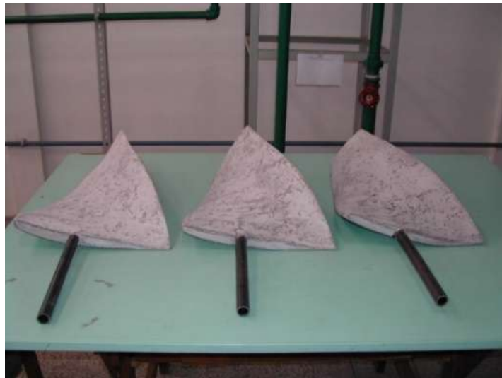
FIGURA 4.25 – Pás da turbina
