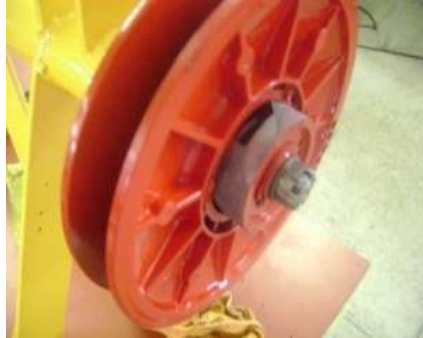
FIGURA 7.45 – Polia variadora montada
