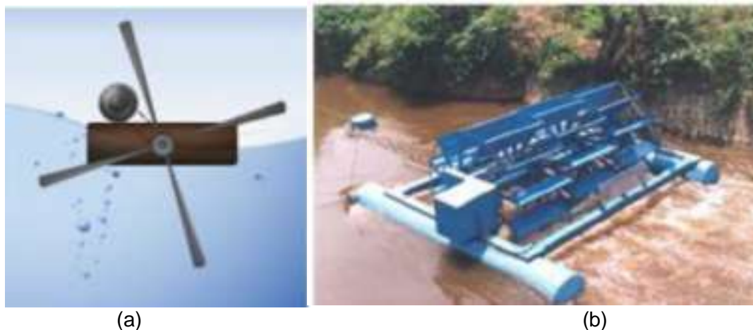
FIGURA 1.5 – Turbinas com eixo no plano da superfície: a) vista transversal, (b) vista paralela
