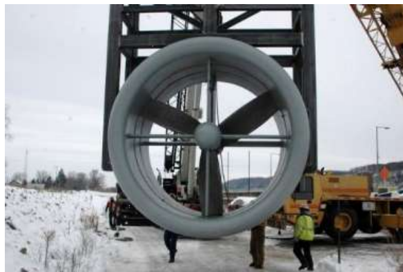
FIGURA 3.15 – Turbina tubular de eixo horizontal
