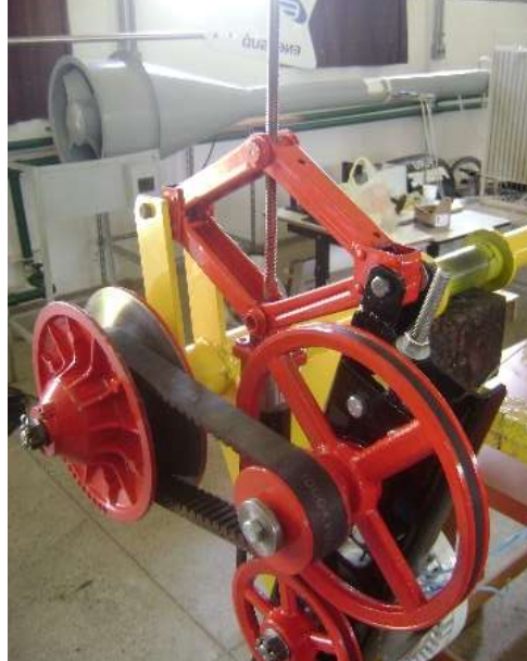
FIGURA 7.50 – Macaco eletromecânico e polias.
