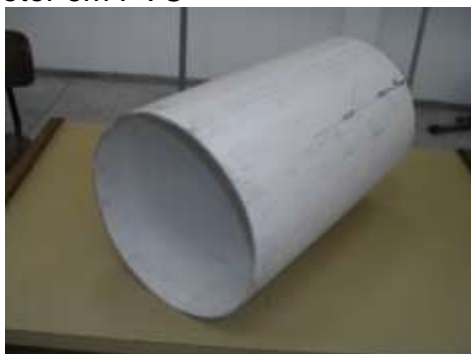
FIGURA 4.26 – Cubo do rotor em PVC
