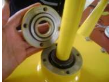
FIGURA 7.30 – Vedação da caixa selada FIGURA 7.31 – Vedação do eixo inferior
