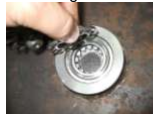
FIGURA 7.27 – Sede para os rolamentos – flange soldado
