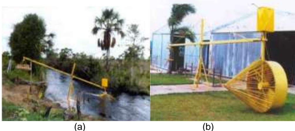
FIGURA 2.1 – 3ª THC Geração 1 UnB: (a) em funcionamento, (b) fora d'água
