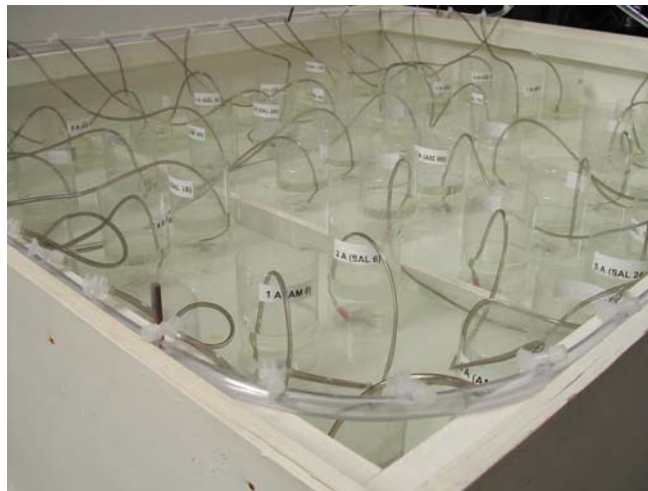
Figura 2. Tanque com banho-maria e recipientes plásticos utilizados nos testes de estresse à salinidade e à amônia.
