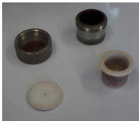
Figura 11 - Foto da bomba de teflon utilizada para o pré-tratamento
