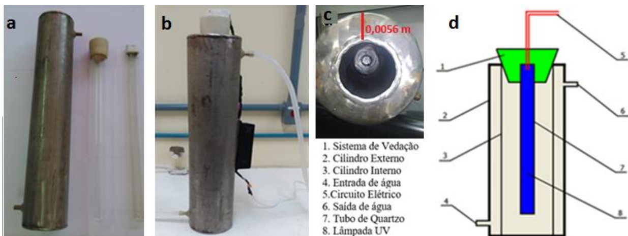
Figura 7 - Reator fotocatalítico construído no Laboratório de Controle Ambiental e Processos Químicos e Biotecnológicos - FURG. a) reator, tubo de quartzo e lâmpada UV; b) reator fotocatalítico; c) parte interna do reator d) esquema do reator fotocatalítico.
